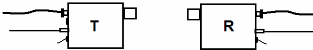
FIGURA 4. Trasmisor T y receptor R en posición para sintonizarlos.
